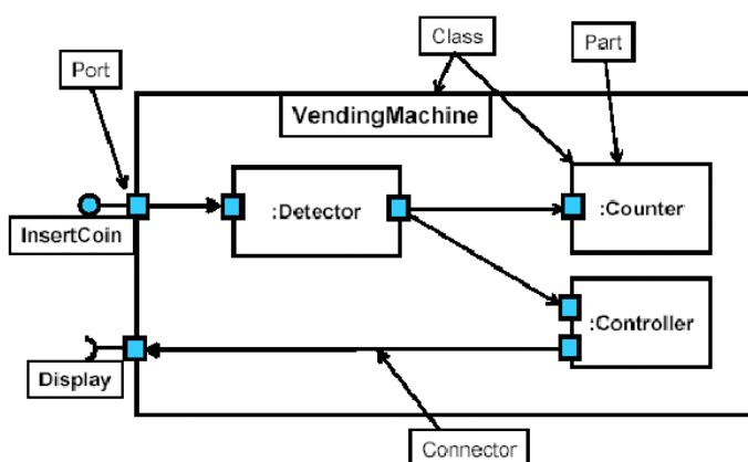
diagramma di struttura composita per un distributore automatico ...
