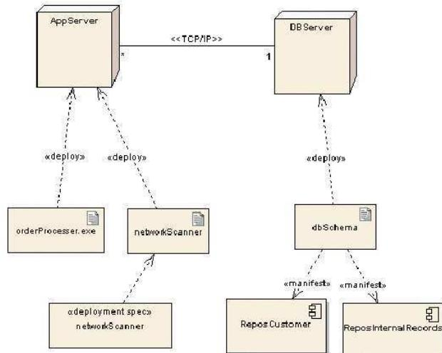
diagramma di deployment per un server di applicazioni
