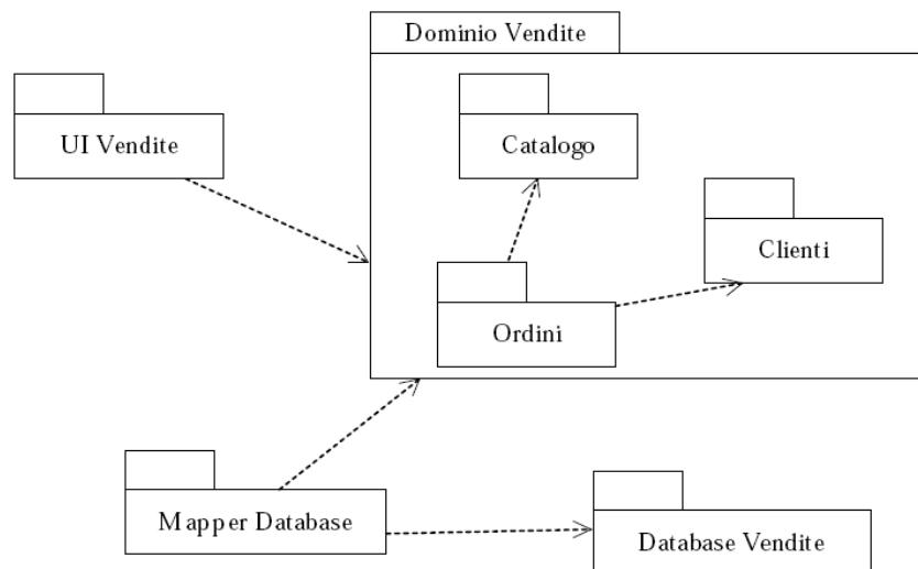
diagramma di package per un sistema di gestione delle vendite
